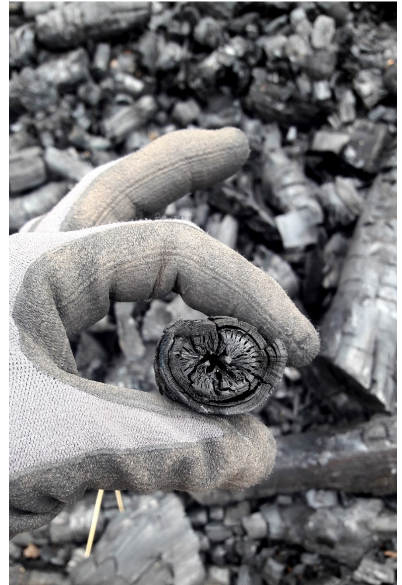
Abb. 4: Pflanzenkohle aus Herstellung im Erdtrichter
