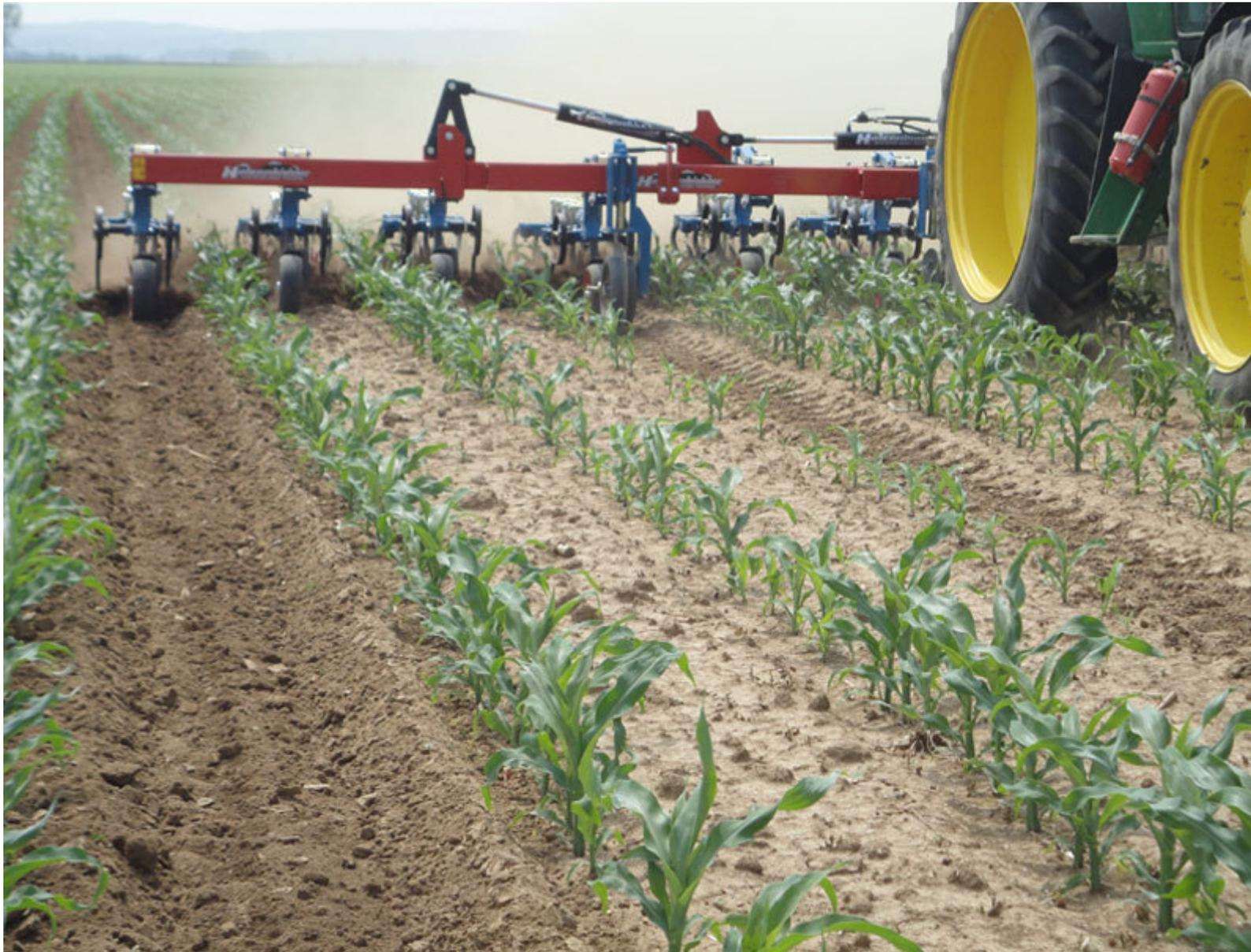
**Abb. 9: Einsatz der Rollhacke in Mais mit stärkerer Häufelwirkung**
