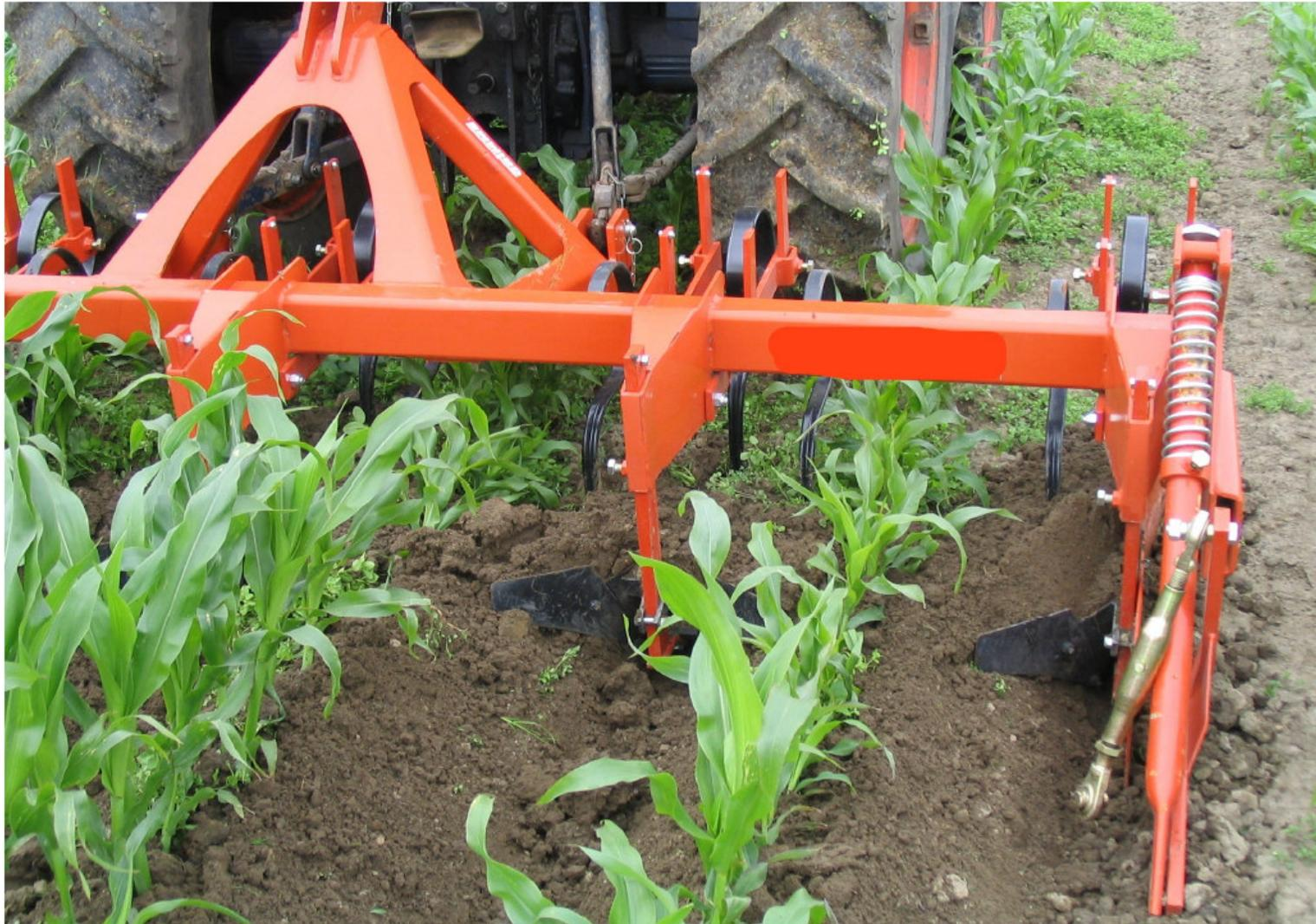
**Abb. 10: Einsatz der Scharhacke mit Häufelkörper in Mais**
