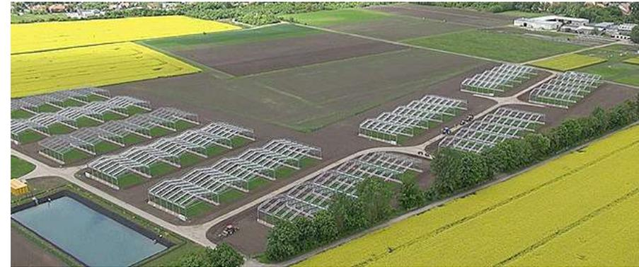
GCEF ist ein großes Feldexperiment für die Untersuchung der Folgen des Klimawandels für Ökosystemprozesse in verschiedenen Landnutzungstypen. Die GCEF besteht aus 50 Versuchspartzen mit einer Größe von 16 m x 24 m.
